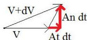
Plaçons-nous maintenant dans le cas le plus général, le point pesant étant en  $M$  au temps  $t$ , avec une vitesse  $V$ , et en  $M'$  au temps  $t + dt$  avec une vitesse  $V + dV$ . On a  $dV = A dt$  où  $A$  est le vecteur accélération, lui-même connu à partir des forces agissantes par  $F = mA$ . Le vecteur  $dV = A dt$  se décompose en deux vecteurs  $At dt$  et  $An dt$  portés l'un par la tangente à la trajectoire, l'autre par la perpendiculaire à cette tangente.
